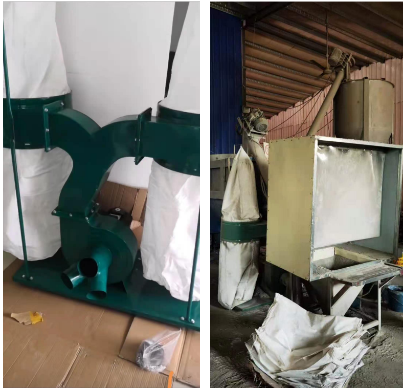
图 3 项目粉尘废气治理措施图
