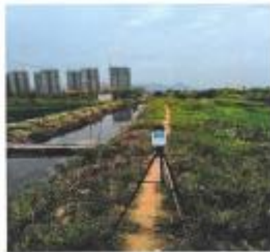
东涌断面 2 距公路中心 60 米处噪声监测
