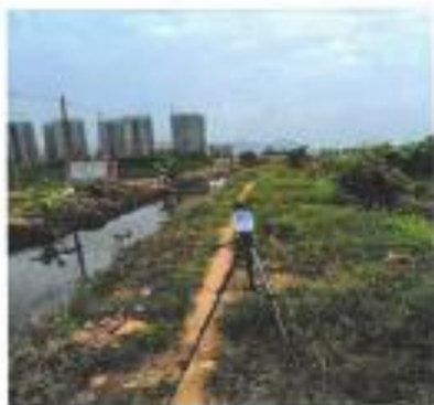
东涌断面 2 距公路中心 40 米处噪声监测
