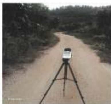
衰减断面 1 距公路中心 80 米处噪声监测
